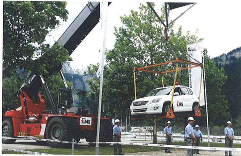
Eindrucksvolle Vorführung der Kraft der langen Fasern: Ein Pkw wird am Gewindetubus aufgehängt
